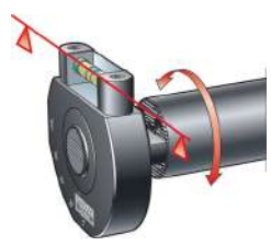
Прикрепите приспособление к рифленому торцу
