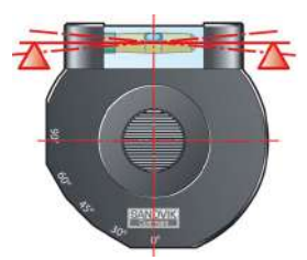
Поворачивайте оправку до установки в правильное положение
