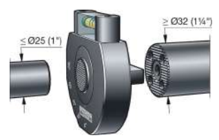
Поворачивайте оправку до установки в правильное положение
